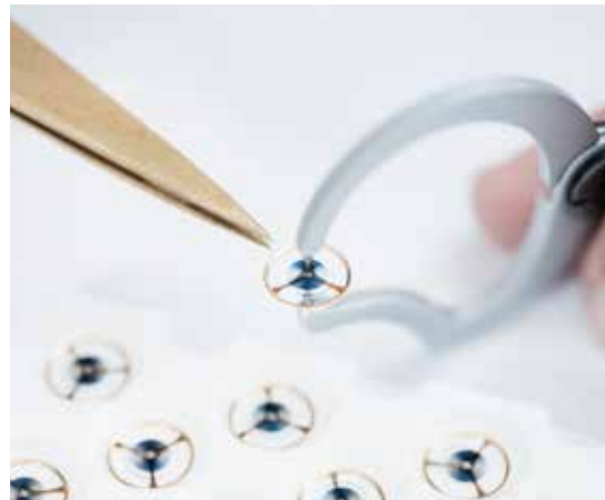
DIESE KLEINEN ELEMENTE SIND TEMPERATURGEBLÄUTE UNRUHSPIRALEN FÜR DAS NOMOS SWING-SYSTEM.
